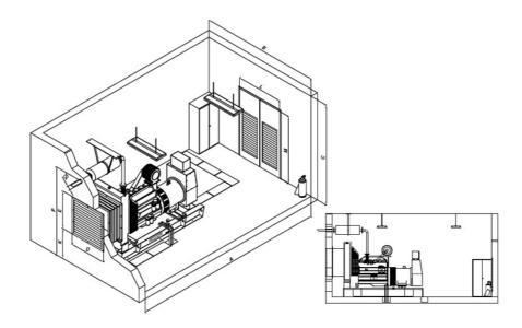
Рис. Схема генераторного помещения открытого типа
