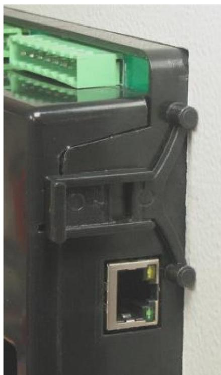
Установка пружинной скобы
